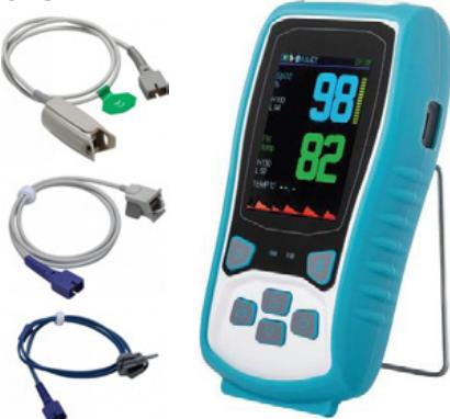
A360 je neinvazivni oksimetar s OLED ekranom za prikaz mjerjenja saturacije (SpO2), brzine pulsa (PR), snage pulsa i pletizmograma. Napajanje je baterijsko, kompaktan je, lagan i jednostavan za rukovanje. Uredaj je prikladan za odrasle i djecu.
