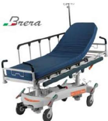
Namijenjeni za prijevoz, njegu i liječenje pacijenata. Hidraulički stretcher, 2-sekcijska ležna ploha iz žičane mreže ili HPL-a, 2 teleskopska stupa, podesiva visina i Trendelenburg/ Antitrendelenburg pozicije pomoću nožnih pedala. Podesivo uzglavlje pomoću ručice (plinski cilindar). Konstrukcija izradena iz čelika, zaštićena epoksi praškastom bojom obrađeni elektrostatskim postupkom sa BiocoteR antibakterijskom zaštitom. 4 utora za infuzijski stalak. Uzdužno sklapajuće sigurnosne ograde.
