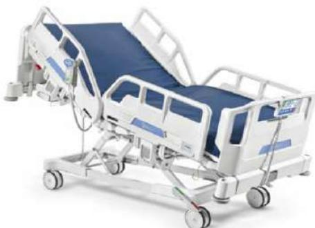
Ležajna ploha u 4 sekcije, čelični profili sa PP pokrovima, koji se mogu ukloniti radi lakšeg čišćenja. Krevet sa 4 elektromotora. Električno podešavanje visine, uzglavlja, bedrenog dijela, Trendelenburg/ Antitrendelenburg pozicije, ručno podešavanje nožnog dijela. Ručni daljinski upravljač za pacijenta i kontrolni panel za medicinsko osoblje. Autoregresija, auto-kontura.
